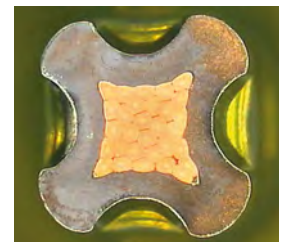
Querschnitt eines Vierdorncrimps Cross-section of a four-indent crimp
